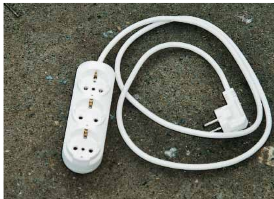
Im Haushalt übliche Mehrfachsteckdosen sind für den rauen Betrieb auf Baustellen nicht zugelassen.
