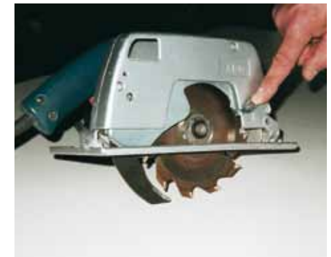
Der Abstand zwischen Spaltkeil und Zahnkranz darf höchstens 5 mm betragen.
