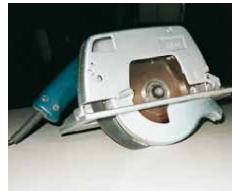
Schutzhauben an Kreissägen müssen nach dem Schnitt selbsttätig in die Schutzstellung zurückkehren.
