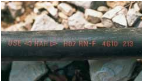
Als flexible Leitungen nur Gummischlauchleitungen verwenden. Kennzeichnung z.B. HO 7 RN-F oder AO 7 RN-F.
