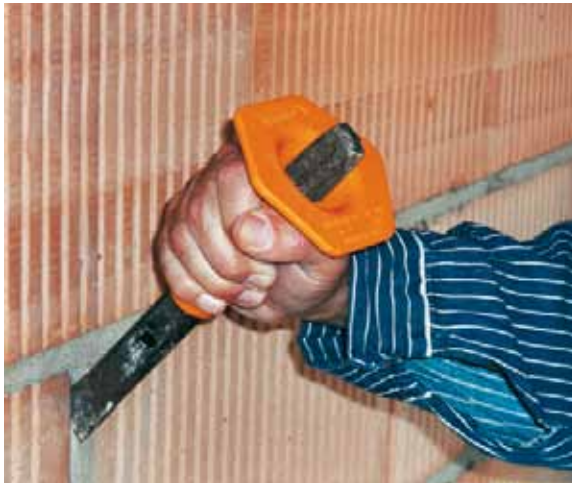
Bewährter Schutz der Hände: aufsteckbarer Handschutz.
