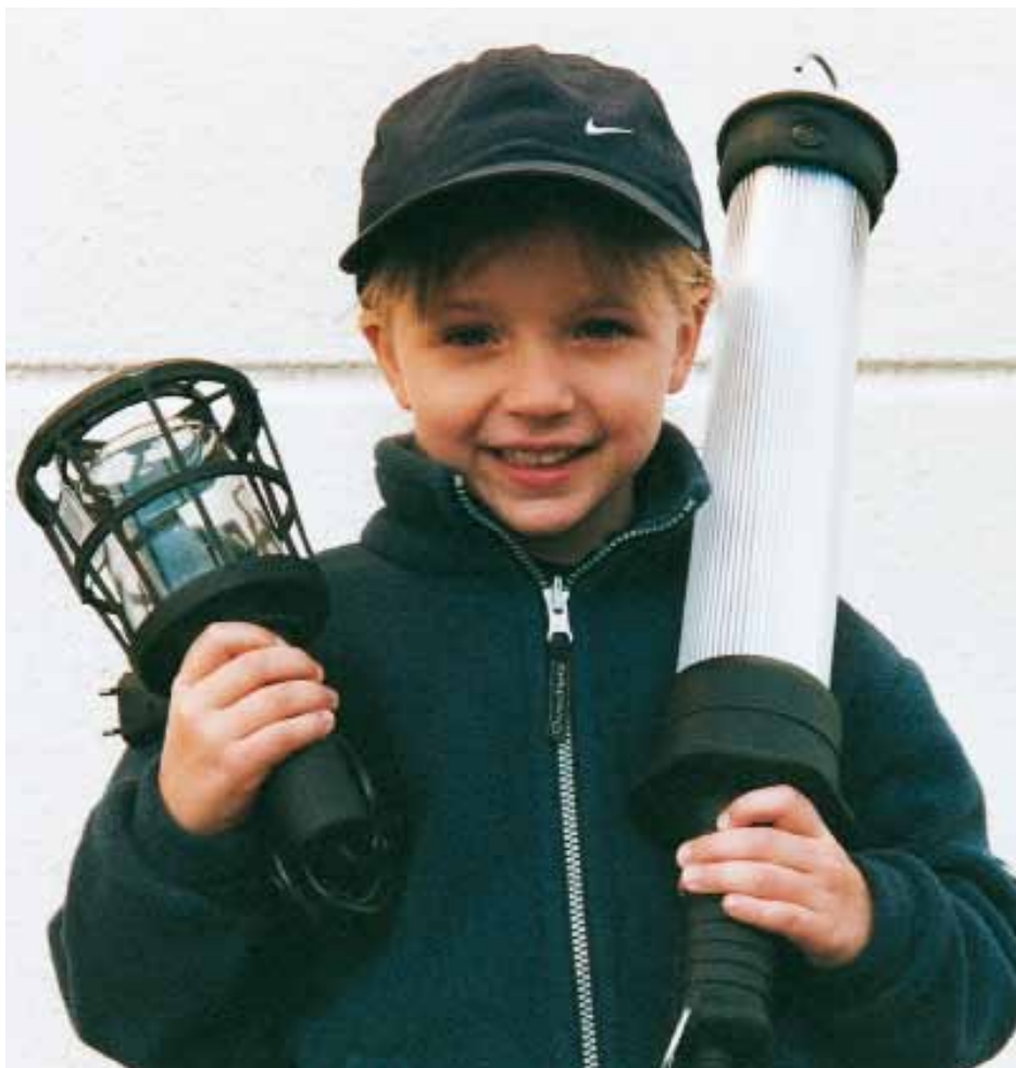
Leuchten und Handleuchten müssen eine Schutzisolierung haben und vor Spritz- und Regenwasser bzw. vor Strahlwasser geschützt ausgeführt sein.
