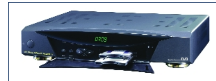
Bild 3.7-5: Set-Top-Box mit mehreren Conditional Access Modulen
