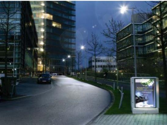
bestückt. Zwischen Stadttor und Gehry-Bauten wurden zehn Lampen mit jeweils 25 LEDs errichtet. 360 Watt reichen aus, um die knapp 200 Meter lange Straße zu beleuchten.
