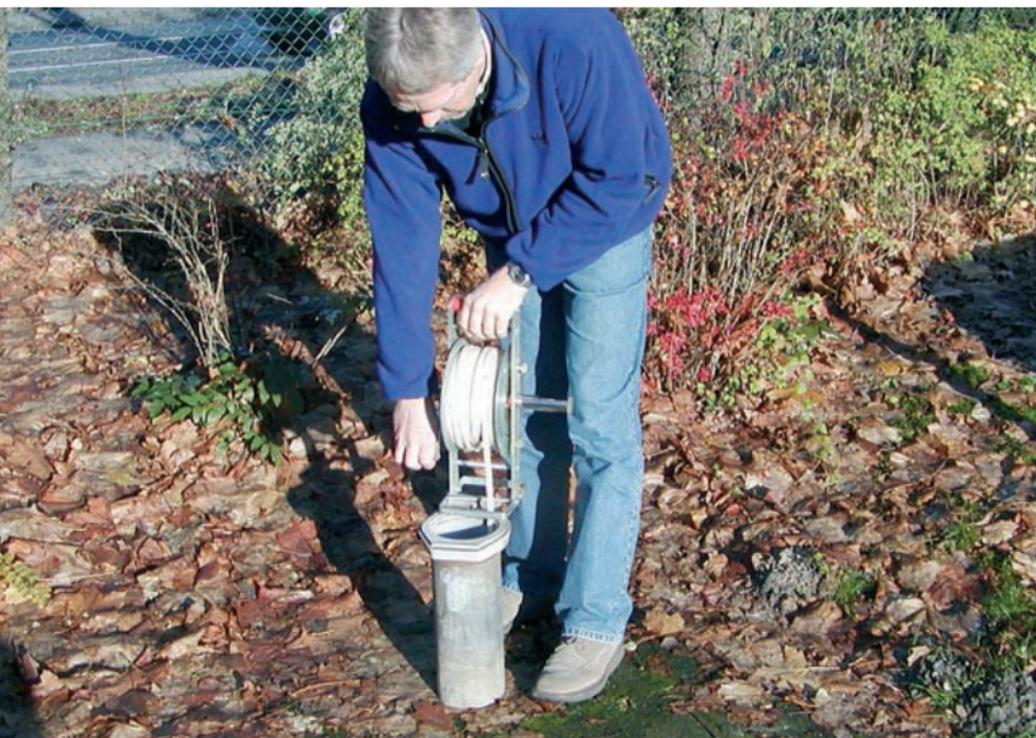
Grundwassermessung mit Lichtlot
