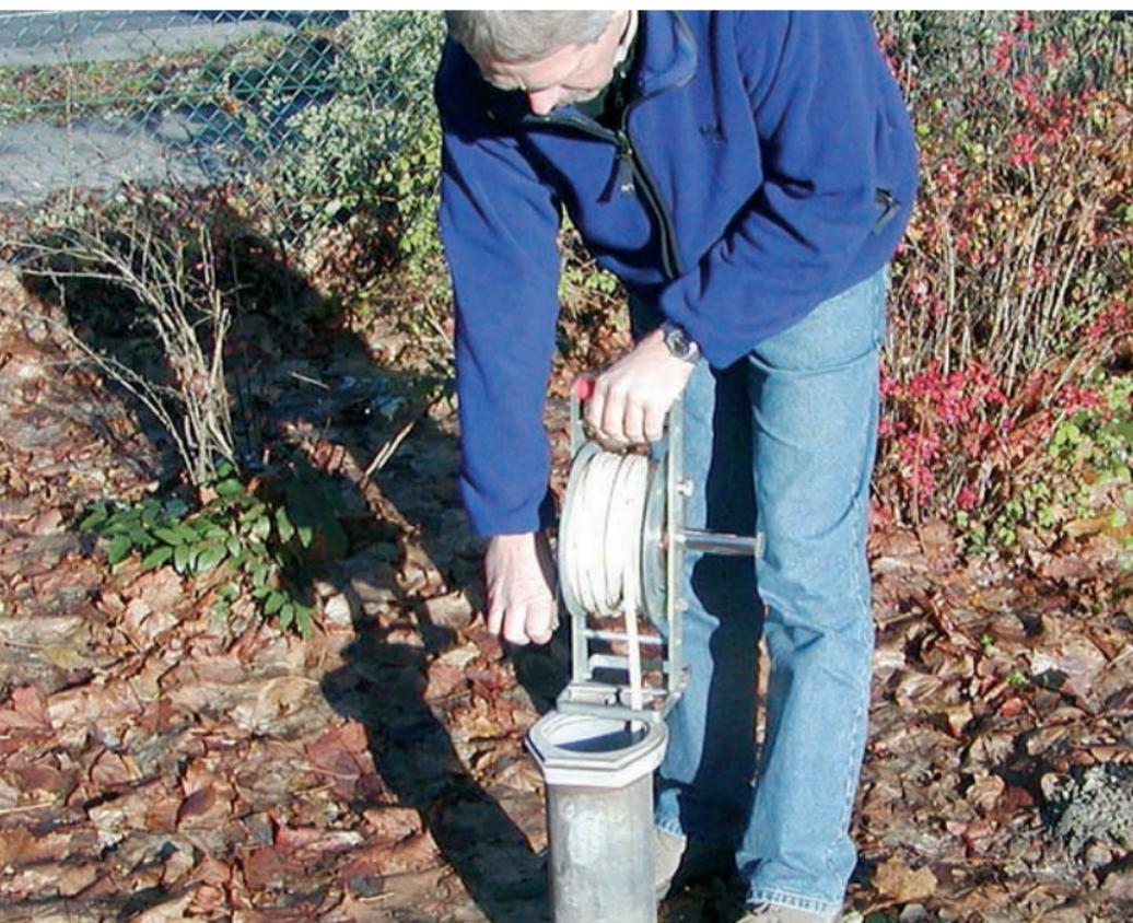
Grundwassermessung mit Lichtlot
