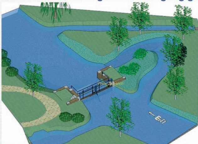
Umgehungsgerinne als Fischeaufstieg (Baumaßnahme in 2007)
