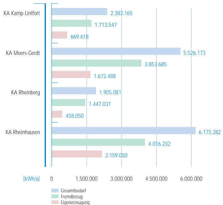
Energiebilanz 2006 der Kläranlagen mit Schlammfäulung
