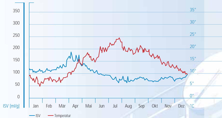
Kläranlage Hoerstgen – ISV
