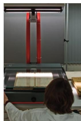
**Abb. 13:** Digitalisierung von Archivgut mit Hilfe eines Aufsichtsscanners im Technischen Zentrum des Landesarchivs NRW (Foto: Gerhard Milting)
