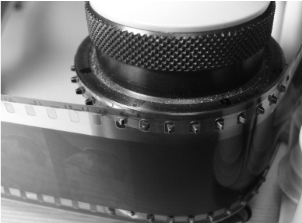
Über einen Transportzahnkranz geführter Film – Detail eines Filmbearbeitungstischs
