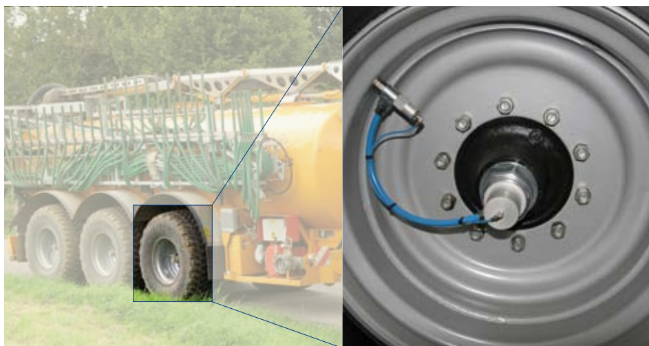
PTG-Reifendrucksystem für Güllewagen
