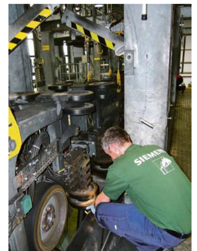
Die Zeit zwischen 0.45 Uhr und 3.45 Uhr nutzen die Siemensmitarbeiter für Arbeiten am Fahrwerk des SkyTrains.
