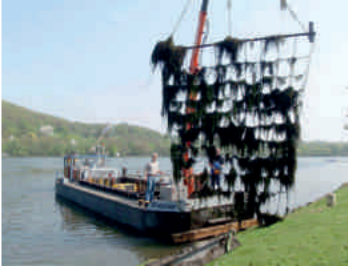
Bild 10.9: Polterkette nach ihrem Einsatz im Baldeneysee am 28. April 2009 Fig. 10.9: Dredging chain after being used in Lake Baldeney on April 28, 2009
