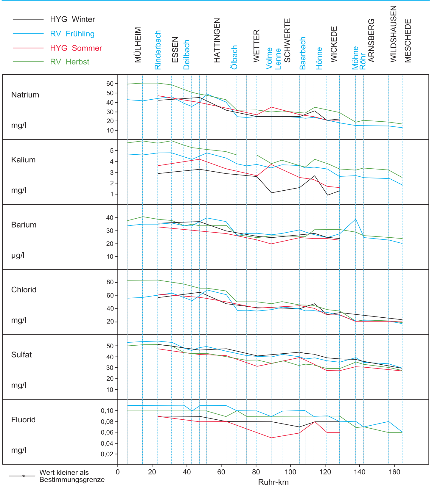
Bild 28.6: Die Wasserbeschaffenheit der Ruhr nach Analysen des AWWR-Ausschusses „Wassergüte“ Fig. 28.6: Water condition of the Ruhr according to analyses of the AWWR water quality committee
