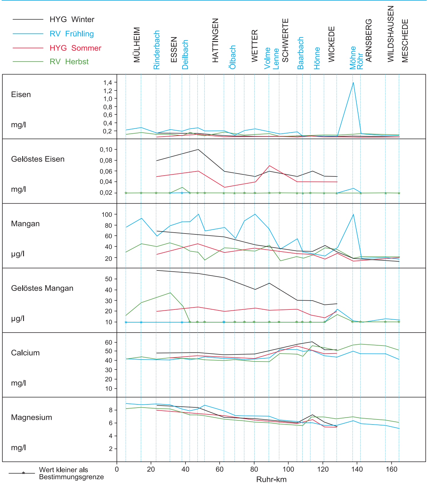
Bild 28.5: Die Wasserbeschaffenheit der Ruhr nach Analysen des AWWR-Ausschusses „Wassergüte“ Fig. 28.5: Water condition of the Ruhr according to analyses of the AWWR water quality committee
