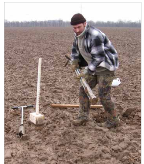
Entnahme einer Bodenphysik-Probe mittels Folienprobennehmer
