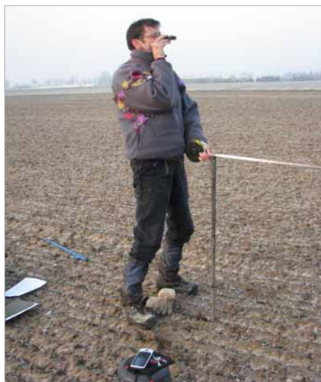
Einmessen der acht Beprobungspunkte an einer Probenentnahmestelle
