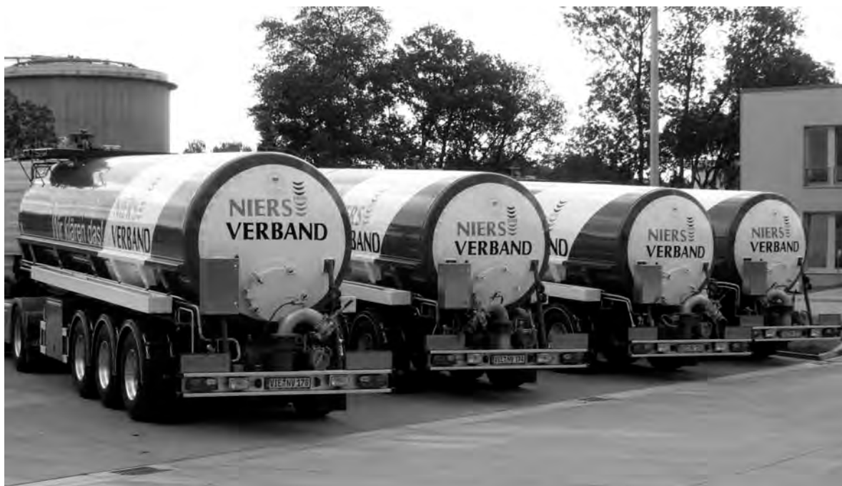
Neue Tankauflieger zum Transport von Abwasser und flüssigem Klärschlamm
