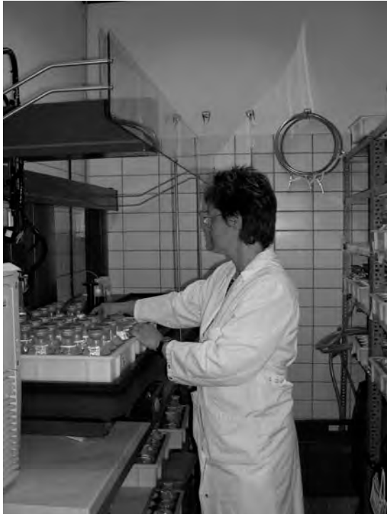
Mirjon van Dijk bei der Bestimmung des biochemischen Sauerstoffbedarfs mittels Mini-Lab
