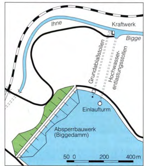
Übersichtsplan des Absperrbauwerks und des Kraftwerks
