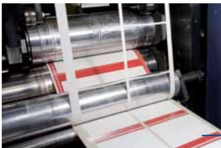
3. Desweiteren werden die so genannten „Klischees“, die das Motiv des Etiketts enthalten (je Farbe eines), auf weitere Rollen aufgeklebt.
