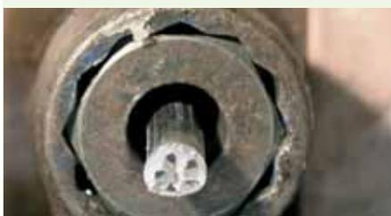
Seelen) in den Draht formt und dabei das heiße und flüssige Flussmittel in die Seelen führt. Es gibt ein- und mehrseelige Lötdrähte; zu sehen ist hier ein 5-seeliger Draht. An dieser Stelle ist der Lötdraht allerdings fingerdick (Durchmesser ca. 13 mm) und daher zum Löten noch nicht geeignet.
