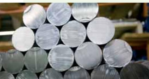
Gussformen eingefüllt und dadurch werden Pressbolzen hergestellt.
