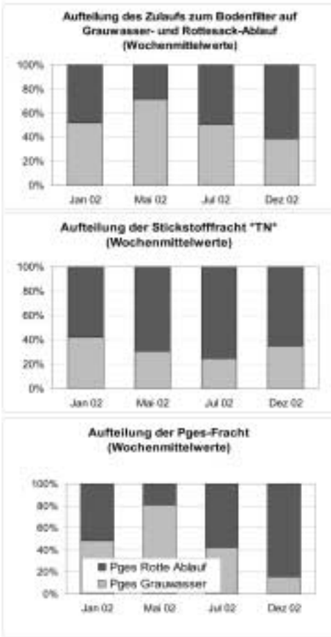
Abb. 5-9: Aufteilung der Wassermengen, Stickstoff- und Phosphorfrachten auf die beiden Teilströme Grauwasserzulauf und Rottesack-Ablauf
