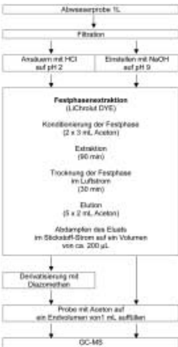
Abb. 2: Schema zur Analytik von Arzneimittelwirkstoffen (Matrix Abwasser)
