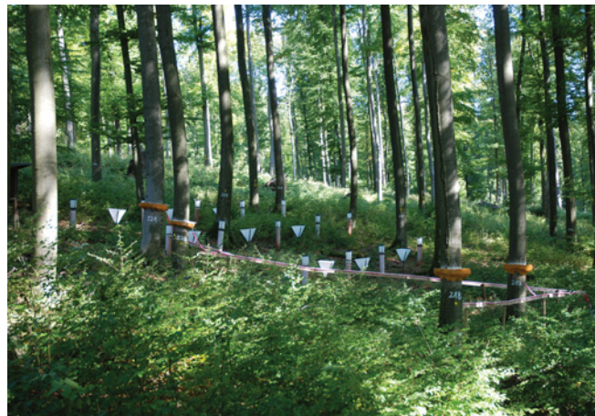
Abbildung 7.5-8: Depositionssammler für die Kronentraufe, den Stammabfluss und den Streufall in einem Buchenbestand im Sauerland
