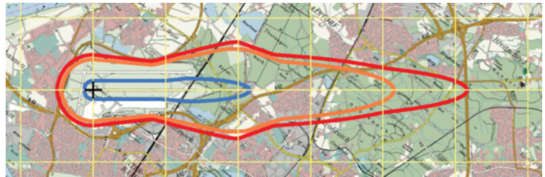
Abbildung 1.6-7: Konturen der Flächen, in denen ein Maximalschallpegel von 85 dB(A) erreicht oder überschritten wird für den Abflug von vergleichbaren Flugzeugtypen verschiedener Generationen:
