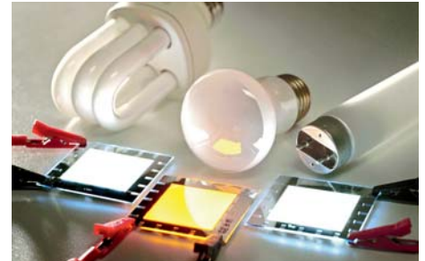
Licht der 4. Generation: Hauchdünne organische Leuchtdioden (OLEDs) bieten vielfältige, innovative und energiesparende Lichtenwendungen
