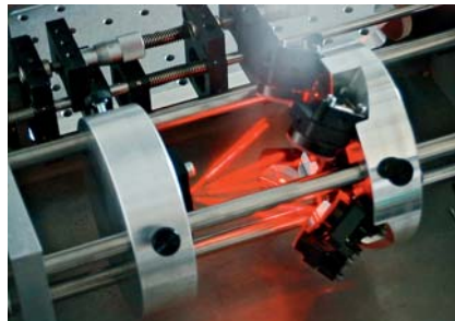
Scheiben-Ringlaser mit einem Helium-Neon-Laser: Demonstration eines Pumplichtstrahlengangs
