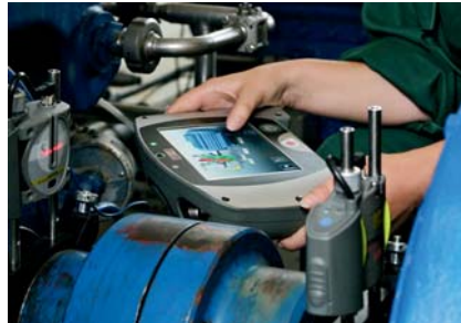
Exakte Messung, übersichtliche Darstellung: Laseroptische Ausrichtsysteme mit kabelloser Signalübertragung liefern schnell Ergebnisse
