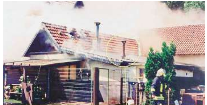
Auf diesem „frühen“ Bild (die Feuerwehr arbeitet noch kräftig, Dachhaut noch vollständig) ist ein zweiter Schornstein erkennbar. Es konnte dann nachvollzogen werden, dass der Hauseigentümer unterhalb dieses Schornsteins mit einem Gasbrenner Schweineohren geröstet hatte, wodurch letztlich der Brand entstanden ist.
