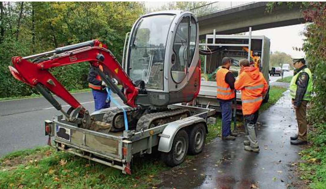
Der Minibagger ist falsch befestigt. Bei einer Vollbremsung wäre er auf die Fahrbahn gestürzt.
