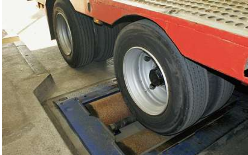
Auf die Rolle: Die Bremsen des Aufliegers werden im Prüfzentrum kontrolliert.
