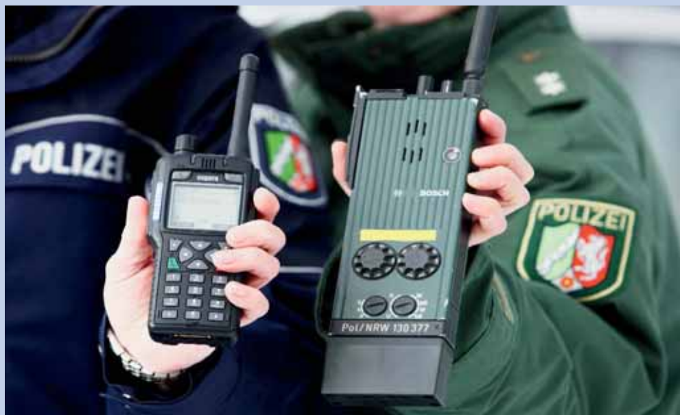
Das neue Handsprechfunkgerät (kurz HRT für Handheld Radio Terminal) im direkten Vergleich mit dem alten FuG10a. Die Leistungsmerkmale des HRT sind u.a. kompaktes, tragbares Endgerät mit integrierten Bedienelementen, Lautsprecher bzw. Mikrofon, GPS-Antenne und eigener Spannungsversorgung (Akku). Das Einlegen einer SIM-Karte (BOS-Sicherheitskarte) ermöglicht die so genannte „Ende-zu-Ende“ verschlüsselte Kommunikation. Externe Schnittstellen bieten Anschlussmöglichkeiten von z.B. einem Mikrofonlautsprecher mit Ohrhöreranschluss.
