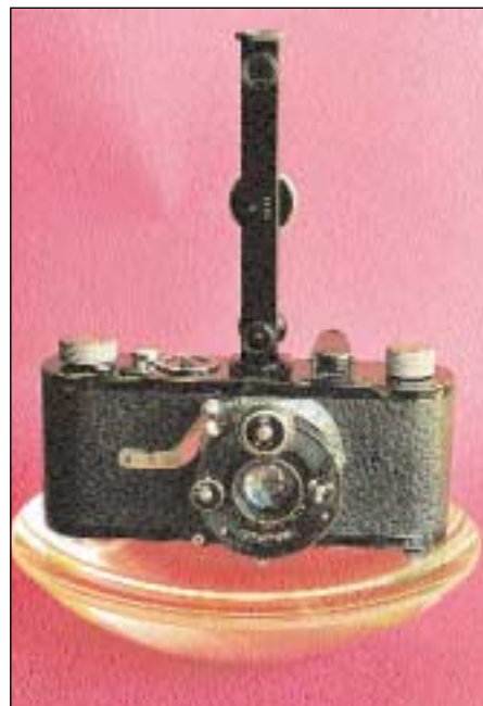
Rädchen-Compur-Leica (Modell B) aus dem Jahre 1925.
