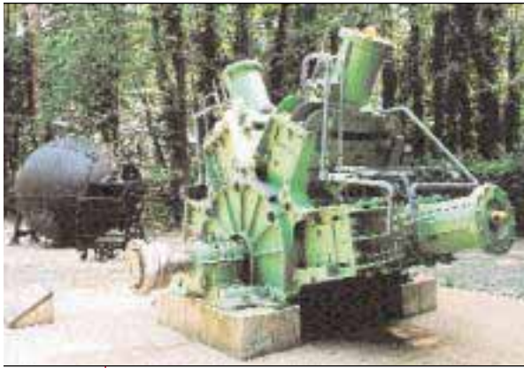
Vor dem Museum stehen im Park verschiedene Großmaschinen zur Papieraufbereitung, u. a. ein gigantischer Holzschleifer aus dem Jahre 1921 und ein Kugelkocher zum Aufweichen und Kochen der Lumpen.
