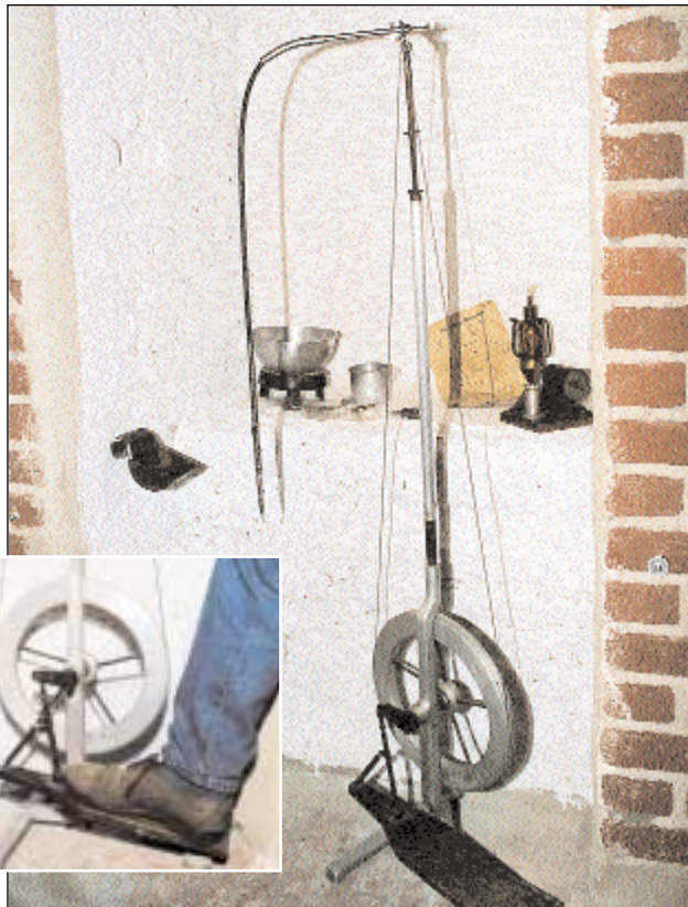
Aus Teilen eines abgestürzten Kampffliegers improvisiert: Tretbohrmaschine eines Uedemer Zahnarztes, bis Dezember 1945 im Einsatz. In der Vitrine eine improvisierte „Praxis“ u. a. mit Originalinstrumenten, Krankenblatt, Brenner zu Desinfektionszwecken, Feuerzeug und Seifenhalter aus einer Geschöshülse mit der üblichen schwarzen Seife.
