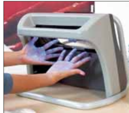
Der „Dermalux-Test“: Die eingecremten Hände werden unter UV-Licht gehalten. Jetzt wird sichtbar, welche Hautstellen ausgelassen wurden.
