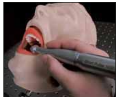
Abb. 4: Links: Kavität nach Präparation mit einem Femtosekundenlaser (Laserparameter: 100 \mu J, 35 kHz, Pulsdauer 700 fs). Rechts: Laserhandstück mit integriertem Scannersystem für fs-Laser (Beide Graphiken mit freundlicher Genehmigung von M. Strassl, TU-Wien).
