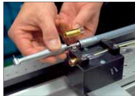
Abb. 3: Das Anwendungsbeispiel zeigt zwei miniaturisierte Laserköpfe und ein kommerzielles Laserhandstück. An dem im Halteblock fixierten Laserkopf sind die Versorgungsleitungen (Lichtleiter und Kühlschläuche) zu sehen. Diese können wie bei dem kommerziellen Laserhandstück durch eine entsprechende Ummantelung geführt werden (grauer Schlauch).
