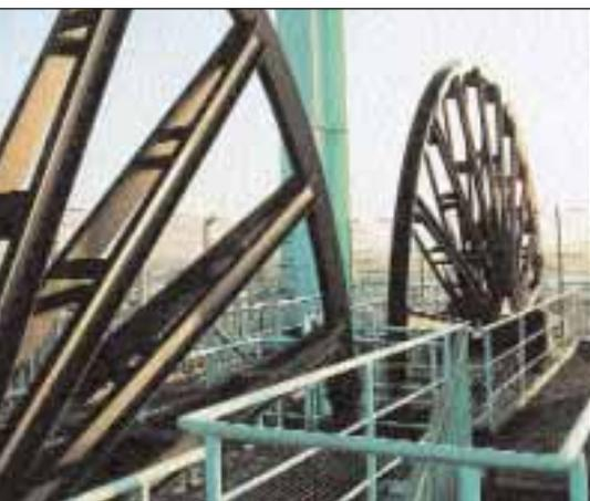
Über die Seilscheiben mit acht Metern Durchmesser wurden einst die Förderkörbe an armdicken Stahlseilen viele hundert Meter tief in den Schacht herabgelassen.
