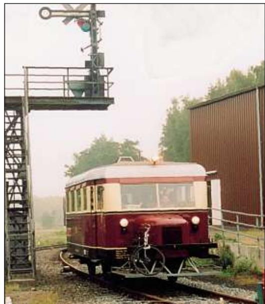
Die Schienenbusse der Bauart Hannover, spöttisch-liebevoll „Schweineschnäuzchen“ genannt (ab 1932 in Wismar produziert), verfügen über zwei 40 PS starke Lastwagen-Benzinmotoren. Angetrieben werden sie jeweils nur von dem in Fahrtrichtung liegenden Motor.
