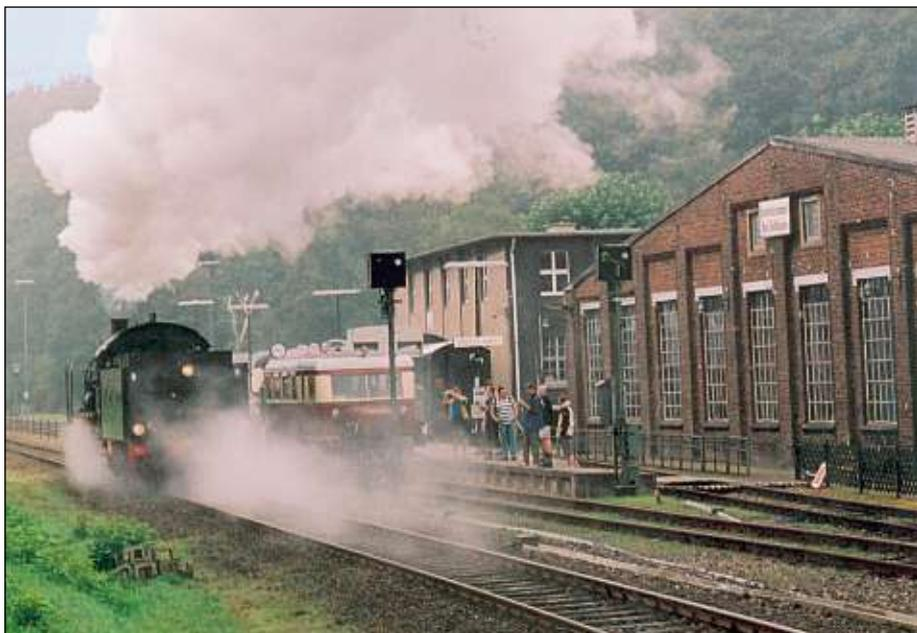
Die P8 des Eisenbahnmuseums von 1918 stand bis Anfang der 70er-Jahre im Betrieb. Später wurde sie schrittweise in den Zustand der 1930er-Jahre zurückversetzt. Zudem erhielt sie Zugbeeinflussung (INDUSI) und Zugbahnfunk, um auf dem DB-AG-Gleisnetz einsetzbar zu sein für Sonderfahrten an den Rhein, in die Eifel oder ins Sauerland. Ende 1999 mussten für die vorgeschriebene Hauptuntersuchung 360 000 Euro investiert werden, um die Lokomotive für die nächsten Jahre wieder fit zu machen.
