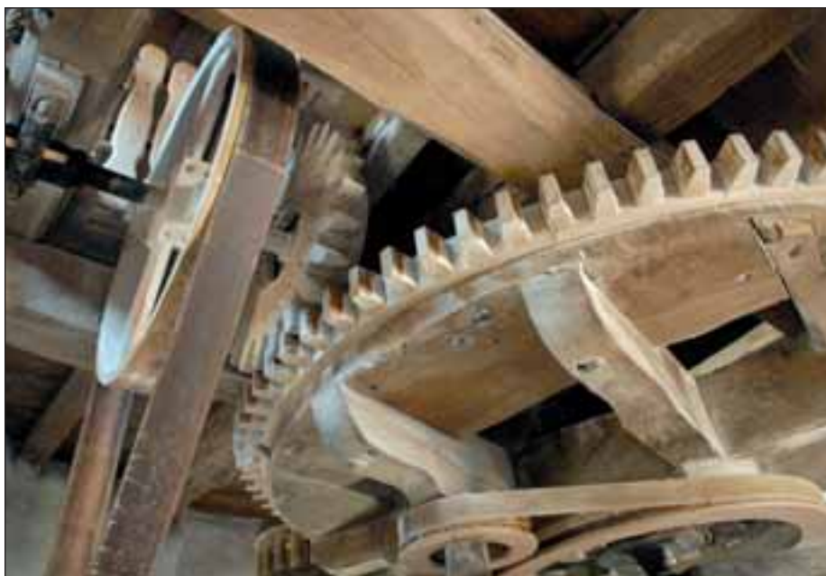
Die mächtigen Zahnräder aus Holz müssen Schwerstarbeit leisten, eine Umdrehung der Flügel bewirkt sechs Umdrehungen der Mühlsteine.
