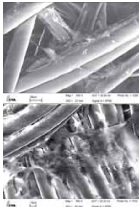
Abb. 3: Environmental Scanning Electromicroscopy (ESEM) Aufnahme humaner MSC auf Vlies (oben) und Gewirk (unten).
