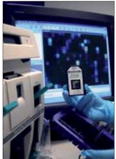
Abb. 4: Exemplarische Darstellung eines Affymetrix DNA-Chips (Vordergrund). Weiterhin zu sehen ist eine Affymetrix Hybridisierungs- und Waschstation (links im Bild). Im Hintergrund ist ein Ausschnitt nach dem Scan des hybridisierten Affymetrix DNA-Chips auf dem Monitor dargestellt. Fotos: Smeets
