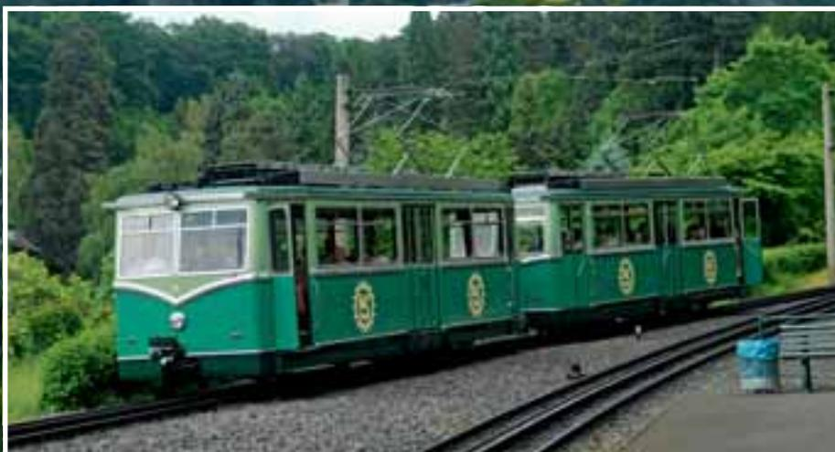
Am Drachenfels überwindet die Meterspurbahn 221 Höhenmeter auf Steigungen bis zu 20 Prozent.
