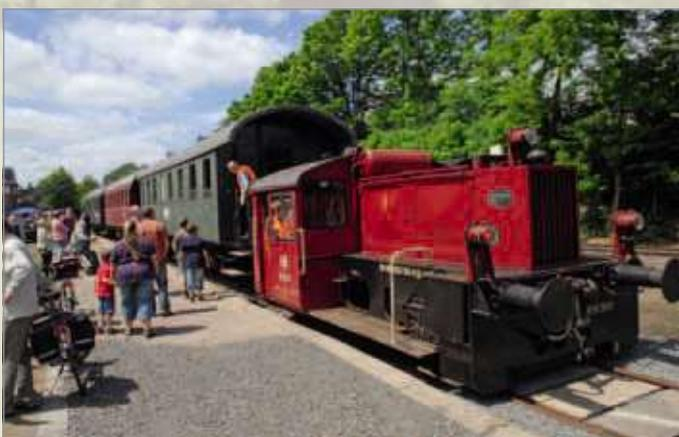
Mit der KÖF II (Kleinlok mit Öl-[Diesel]-Motor und Flüssigkeitsgetriebe) werden die Wagen umgesetzt. Dann begleitet sie den Zug auf die DB-Strecke, weil die Dampflok dort keine Betriebserlaubnis hat.
