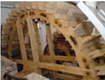
Ein mächtiges hölzernes Wasserrad treibt wie im 18. Jahrhundert sämtliche Spinnmaschinen der Fabrik an und liefert der „Water Frame“, der ersten vollmechanischen Spinnmaschine, heute wieder die Energie.
