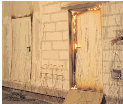
*Flammdurchtritt bei der falsch eingebauten Feuerschutztür*
