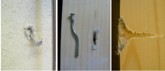
Bild 13 Duktiles Bauteilverhalten von stiftförmigen Verbindungsmitteln [Fotos: Fermacell GmbH, Duisburg]
