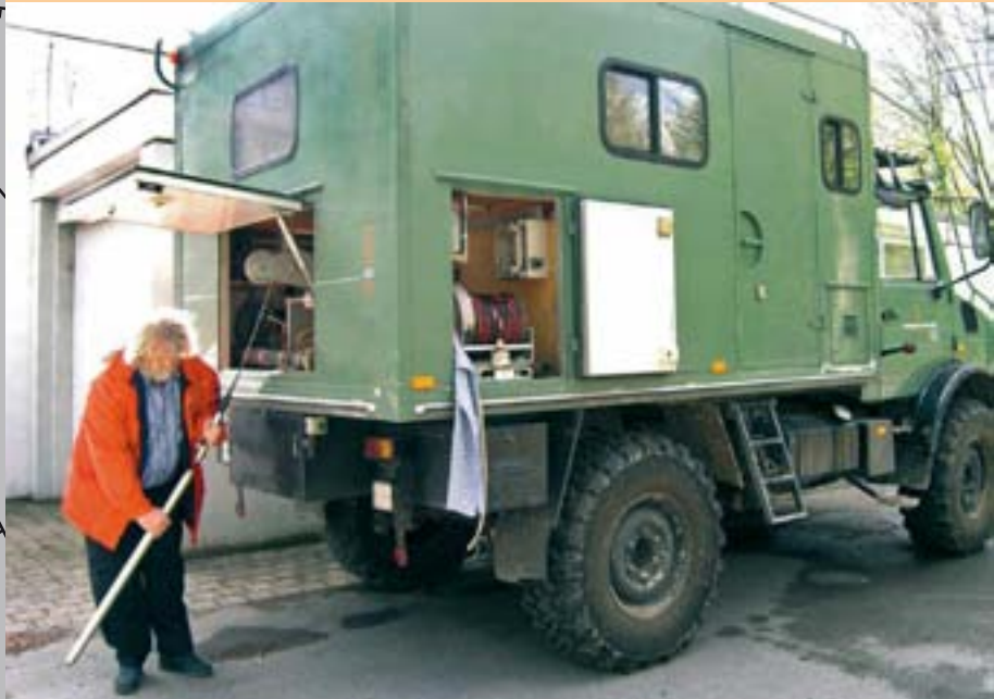
Der Messwagen des geophysikalischen Messtrupps – Vorbereitung auf Bohrlochmessungen
