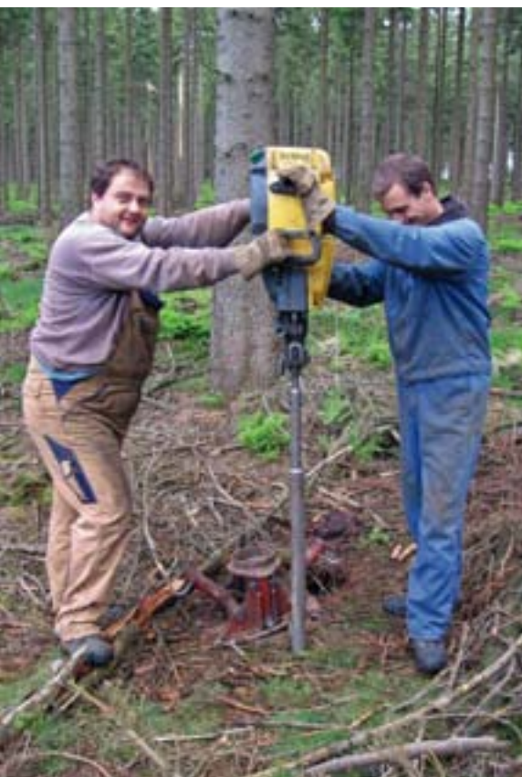
Bodenprobenentnahme für Analysen der Bodendauerbeobachtungsflächen
