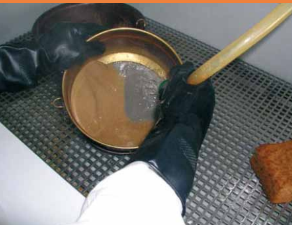
Probenaufbereitung im Labor – eine Gesteinsprobe wird gesiebt.
