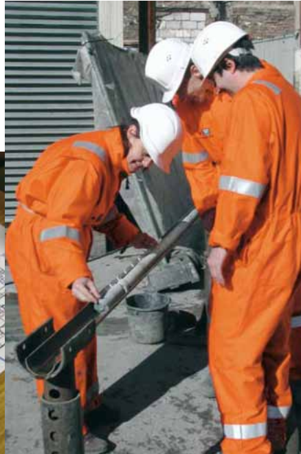
Geologische Aufnahme und Archivierung der Bohrkerne
