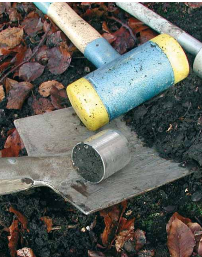
Mit Bodenmaterial gefüllter Stechzylinder zur Bestimmung der Lagerungsdichte
