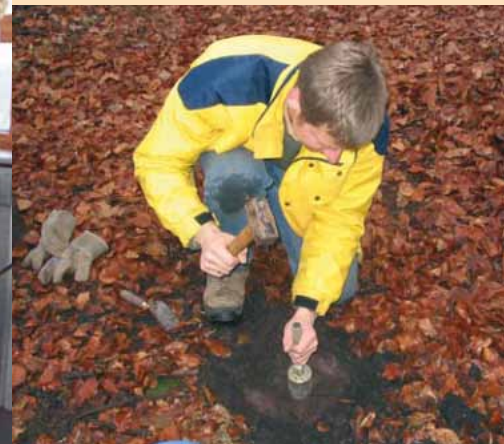
Einschlagen eines Stechzylinders zur Probenentnahme
