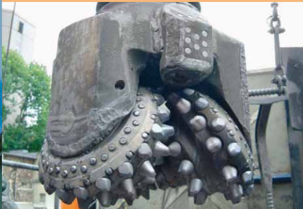
23"-Warzenmeißel – eingesetzt auf der Bohrstrecke 26 – 250 m
