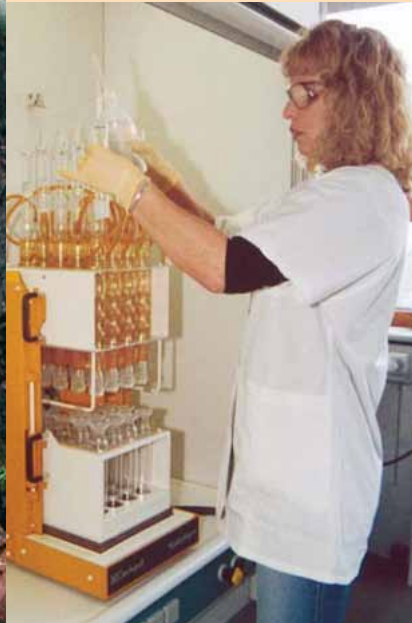
Laborbearbeitung des Königswasser-aufschlusses
