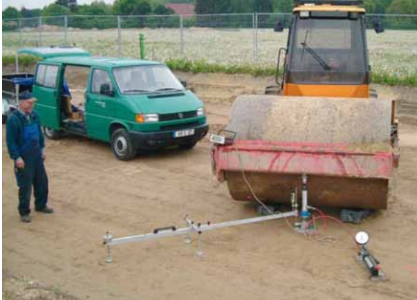
Plattendruckversuch im Versuchsfeld
