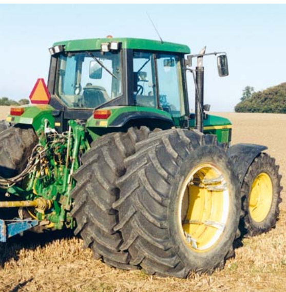
Doppelbereifung mindert den Druck auf den Boden.
