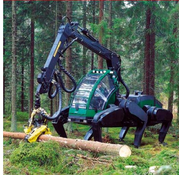
Holzerntemaschinen auf Füßen – eine bodenschonende Alternative (Foto: plustech)
