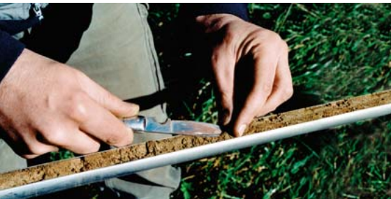
Am Bohrstock werden die wichtigsten Bodeneigenschaften beurteilt.
