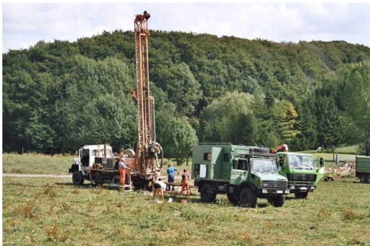
Der Messwagen des geophysikalischen Messtrupps wird auf die Messung in einer kartierbegleitenden Bohrung vorbereitet.
