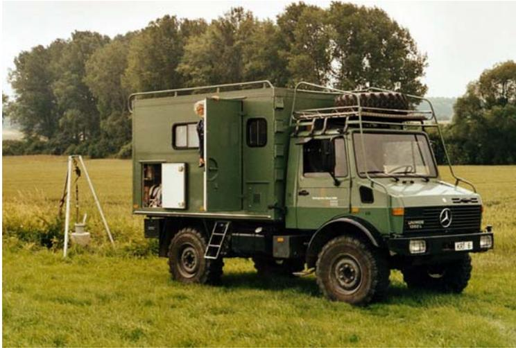
Geophysikalische Bohrlochmessungen an einer Grundwassermessstelle. Das Messkabel der Gamma-Ray-Sonde wird über ein Dreibein geführt.
