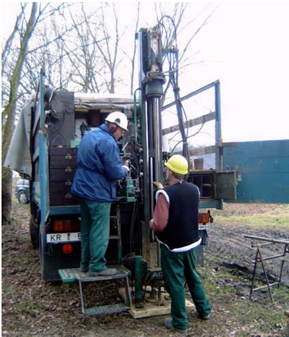
Die oberen Lockergesteinsschichten lassen sich mit Sondierbohrungen erkunden.
