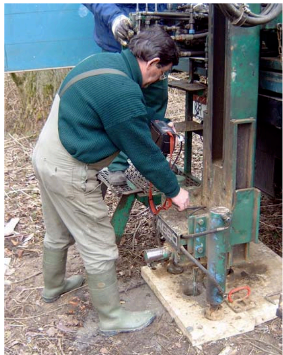
Aus den in der Tiefe lagernden Kohlenflöze kann Methangas, das hier gemessen wird, emporsteigen.
