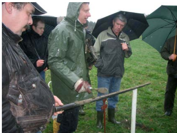
Bodenexperte Albrecht Deppe zeigt im sogenannten „Pürkhauer-Bohrer“ eine flachgründige Rendzina auf der Kuppe bei Börninghausen.
