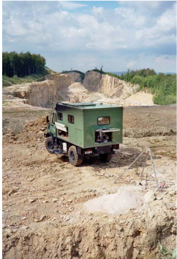
Gamma-Ray-Bohrlochmessungen im Umfeld eines Steinbruchs zur Schichtkorrelation in Bohrungen außerhalb des Abbaubereichs
