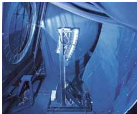
Eines der 24 großflächigen Spiegelteleskope, die nachts die Leuchtspuren der kosmischen Teilchen in der Atmosphäre nachweisen. Links das Eintrittsfenster, Durchmesser 2,2 Meter, in der Mitte die Kamera, die u. a. die Wuppertaler Astrophysiker entwickelt und gebaut haben, rechts der segmentierte, 12 Quadratmeter große Spiegel.
