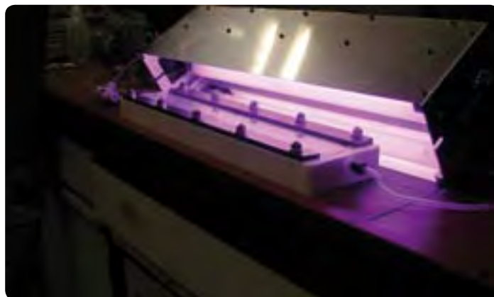
Laborversuch: Kleiner Photoreaktor zur Umwandlung von Luftschadstoffen mit Titandioxid
