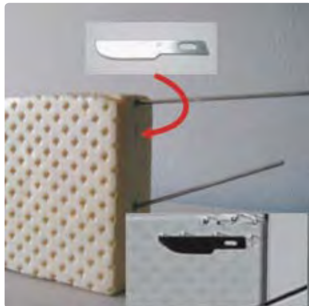
Terahertzaufnahme: Zunächst wird eine Skalpellklinge seitlich in einen aufgeschäumten Kunststoffblock hineingeschoben. Die seitlichen Drähte dienen der Halterung an einem XY-Fahrtisch. Durch eine Scan-Bewegung des Objektes vor der 1-Pixel Terahertzkamera entsteht ein flächiges Bild (siehe Bildausschnitt rechts unten). Neben der Oberflächenstruktur ist in der Terahertzaufnahme die verdeckte Klinge sowie Materialschäden durch das Hineinschieben der Klinge und Drähte (obere Bildkante) zu erkennen.
