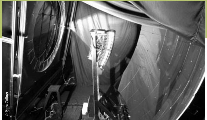
Eines der 24 großflächigen Spiegelteleskope zum Nachweis der Teilchenspuren im Nachthimmel. Links das Eintrittsfenster, Durchmesser 2,2 Meter, in der Mitte die Kamera, die u.a. die Wuppertaler Astrophysiker entwickelt und gebaut haben, rechts der segmentierte, 12 Quadratmeter große Spiegel.
