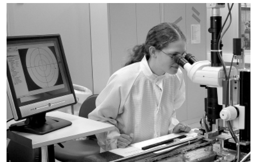
Abb. 3: Montage von Pixeldetektor Modulen auf eine Kohlenstoff-Tragestruktur Fig. 3: Pixel detector module mounting on a carbon stave
