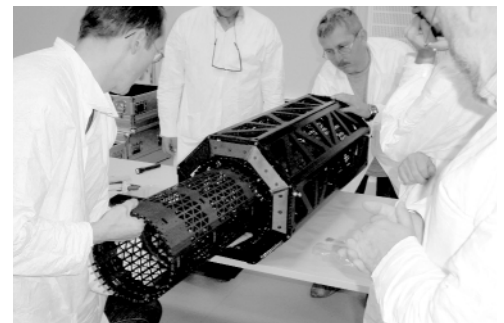
Abb. 2: Testaufbau der Pixeldetektor-Trägerstrukturen Fig. 2: Test assembly of pixel detector barrel structures
