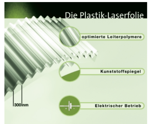
Abb. 3: Prinzipaufbau eines LPPP-basierten Polymer-Festkörperlaser mit DFB-Resonator (Elektrischer Betrieb ist ein Zukunftsziel und noch nicht realisiert.)
