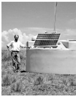
Abb. 6: Ein Solarzellen-betriebener Wassertank zum Teilchennachweis
