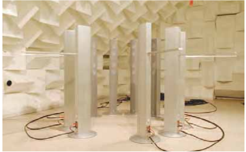
Ein Active Noise Control System bei der Kalibrierung in einem reflexionsarmen Akustiklabor
