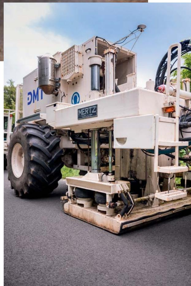
Ein Vibro-Truck im Einsatz: Die Rüttelplatte sendet Schallwellen in den Untergrund
